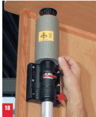
18. Isolierschale zwischen Haltekonsole und Decke einsetzen. (Isolierschale ist nicht im Lieferumfang enthalten. Sie empfiehlt sich besonders für Wintercaravanning).
