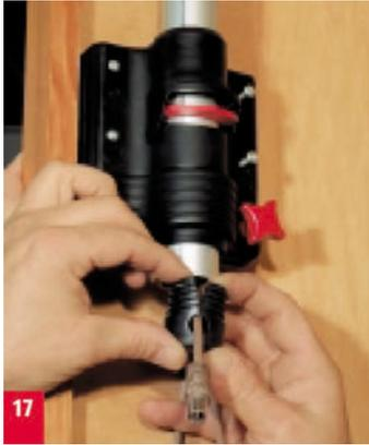
17. Kabel durch geschlitzte Abschlusskappe drücken und aufstecken.
