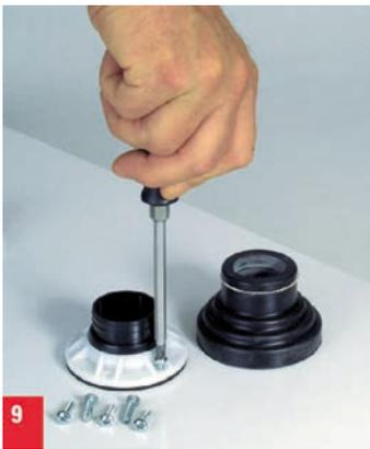
9. Schrauben eindrehen, ohne diese zu überdrehen.
