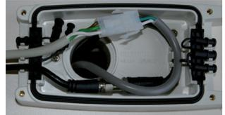
Dachdurchführung ohne Kabelschnittstelle
