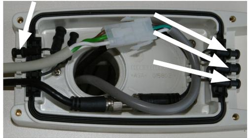
12. Setzen Sie jetzt den Deckel auf das Gehäuseunterteil und schrauben Sie die beiden Teile mit den vier im Deckel vormontierten Schrauben fest (Anzugsdrehmoment:  $M_A = 1-1,5 \text{ Nm}$ ).
